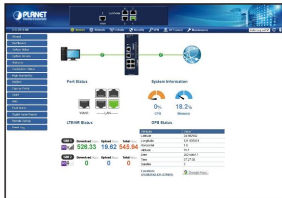
Рисунок 4-3: Основной веб-экран шлюза сотовой связи
