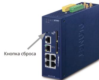
Рисунок 5-1: Кнопка сброса серии ICG-2515-NR
