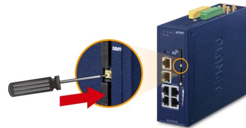
B. Осторожно вытяните лоток из прорези для лотка. Поместите SIM-карту в лоток позолоченными контактами вверх.
